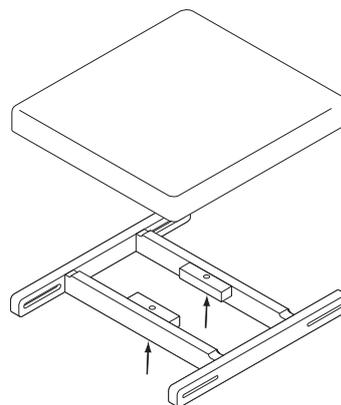
1. 座面は、内側から4つのビスで調整します。奥行き方向にも調整可能です。
