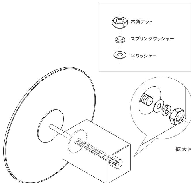
2. 差し込んだ②天板の先端へ平ワッシャー・スプリングワッシャー・六角ナットの順で締め固定します。
