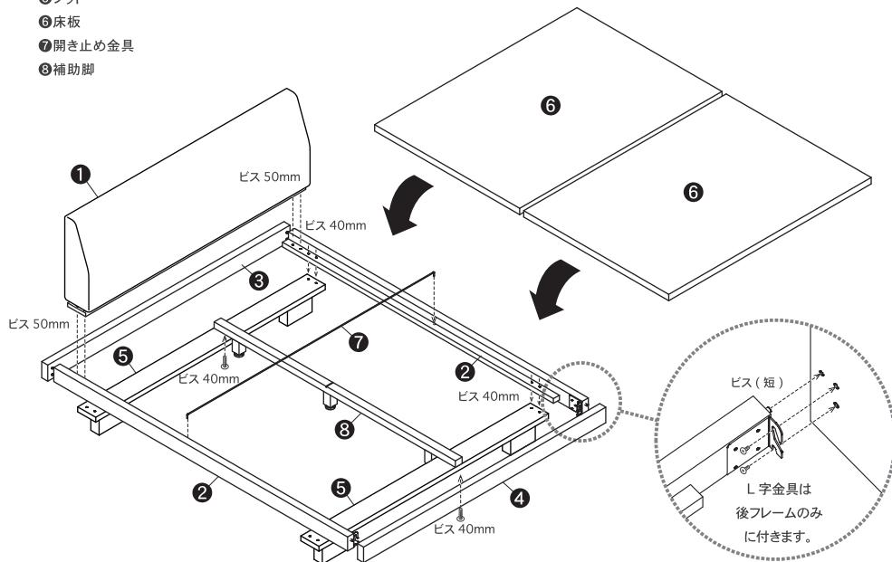
1. ⑤フットに②サイドフレームを固定します。位置を調整しビス40mmを軽めに締めておきます。
