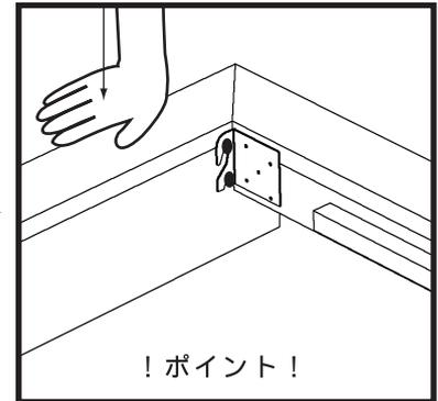
2. ②サイドフレームに③フットフレームを左右同時に差し込み、接合部分を手で押さえながらビスで締め上げて下さい。ヘッドパネルのビスもしっかり締めあげます。
