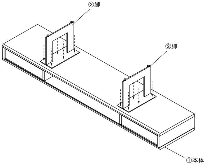
1. ①本体を裏面に置き、②脚を上図のように雌ネジの穴位置に合わせてビスで軽く仮止めしておきます。
